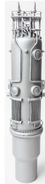
شکل (۵). نمای کلی و برش داده شده سه بعدی از یک ماژول راکتور هسته‌ای NuScale طراحی شده
