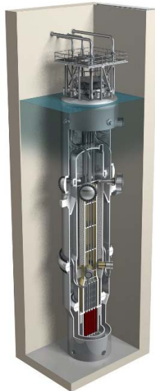
شکل (۵). نمای کلی و برش داده شده سه بعدی از یک ماژول راکتور هسته‌ای NuScale طراحی شده
