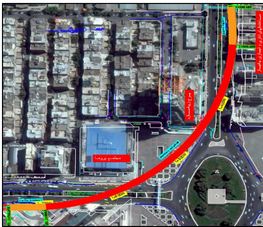
شکل (۳). عکس هوایی از مسیر شعاع قوس ۲۷۰ متر
