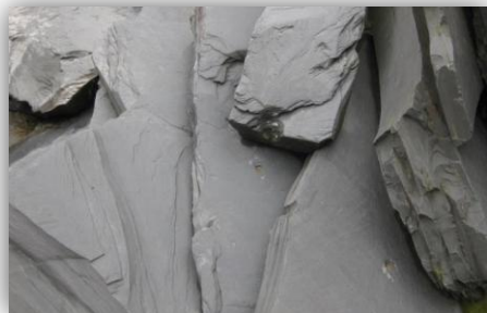
شکل (۴). نمونه سنگ اسلیت با شیستوزیته بالا و تورق‌پذیر
