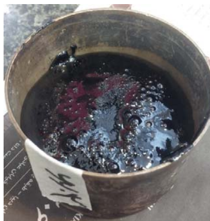
شکل (۳). نمونه قیر بازیافتی پس از استخراج از مخلوط و جداسازی فیلر
