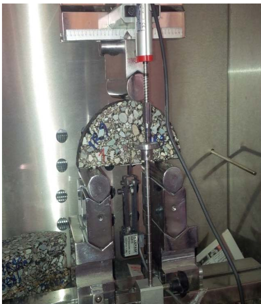
شکل (۸). نمونه نیم‌دایره مخلوط آسفالت بازیافتی تحت بارگذاری خمشی با نرخ LLD ثابت
