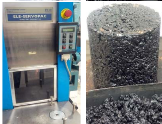
شکل (۶). تهیه نمونه مخلوط آسفالتی متراکم شده به روش ژیراتوری به قطر 150 میلی‌متر
