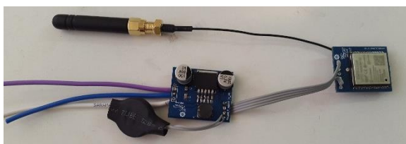
شکل (۶). تصویر یک node کامل لحیم شده
