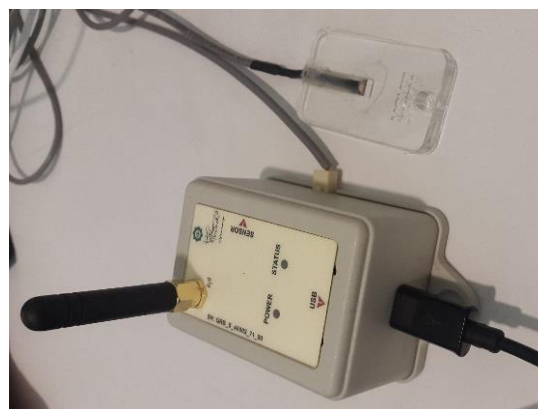
شکل (۸). بخش مرکزی (Gateway) و اتصالات آن
