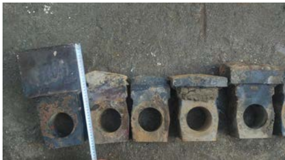
شکل (۱۴). نمونه‌ای از ریپر سنگین نو و سایش یافته
