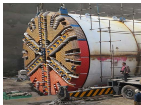
شکل (۱۰). نمای کلی از دستگاه EPB-TBM قطعه شرقی خط ۳ قطار شهری مشهد
