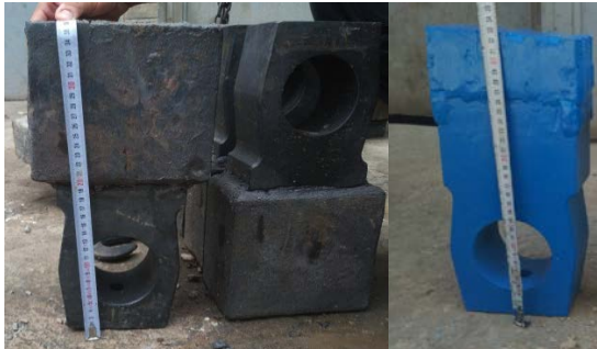
شکل (۱۳). ریپرهای اولیه ماشین حفار (طرح NFM - راست) و ریپرهای سنگین ایرانی (سمت چپ)
