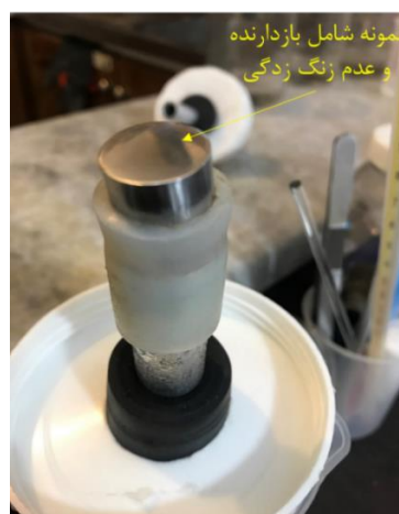
شکل (۵). عدم خوردگی نمونه شامل بازدارنده.
