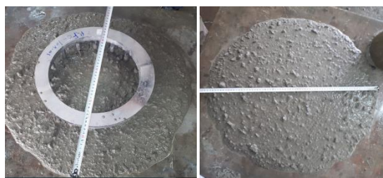
شکل (۲). بتن خود متراکم تحت آزمون پخش‌شدگی اسلامپ و حلقه J
