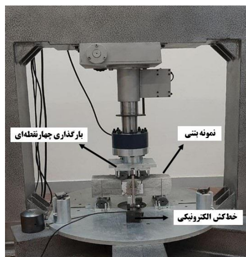
شکل (۲). پیکربندی آزمایش مقاومت پسماند بتن الیافی
