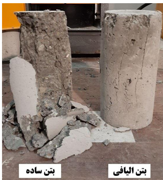
شکل (۳). تفاوت مود شکست بتن الیافی و بتن ساده (شاهد)
