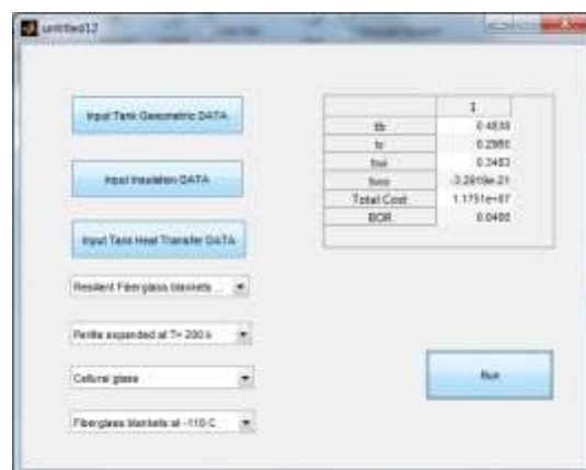
شکل (۴). نمایی از محیط نرم افزاری تدوین شده برای انجام محاسبات طراحی بهینه‌ی سیستم عایق‌بندی مخزن
